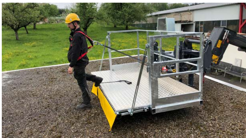
Figure 31 : Plateforme élévatrice PEMP avec possibilité de sécurisation, source : Jakob Fahrzeugbau AG
