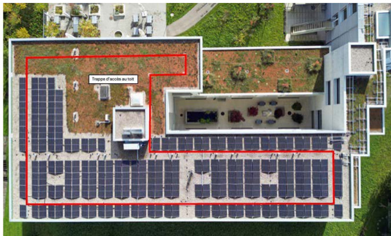
Figure 5 : Maison d'habitation et de soins Wienerberg, Saint-Gall, installation photovoltaïque et végétalisation séparés source : Stadtwerke St. Gallen
