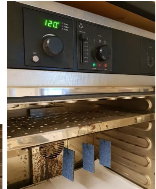
EN 1110 Résistance au fluage à température élevée
