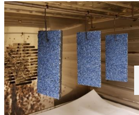
EN 1110 Résistance au fluage à température élevée
