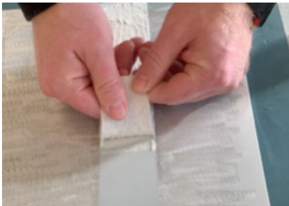
Fig. 3: Test de pelage par traction manuel, pour le PL avec une bande de test de 50 × 100 millimètres
