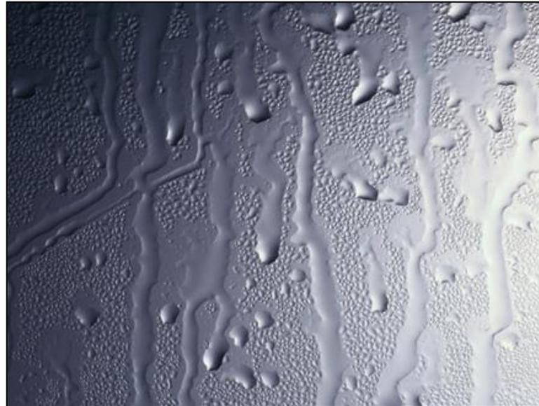
**La vapeur d'eau étant invisible, sa présence est la plupart du temps inconnue. Sauf si elle se condense en eau à la surface d'une partie de construction.**
